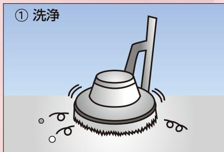
施工面の油泥を除去し、フローンオイルクリーナーSPにて油污を洗い落とし、乾燥させて下さい。
