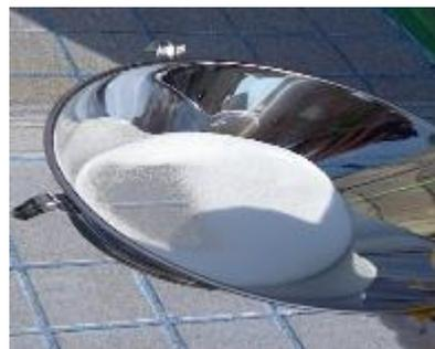
※ステンスふるいに骨材を入れる際に骨材がふるいの下に落下しますので受け皿を用意してください。
