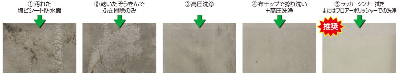
密着結果[X]※剥離の可能性 密着結果[X]※剥離の可能性 密着結果[X]※剥離の可能性 密着結果[○]※密着良好 密着結果[○]※密着良好
