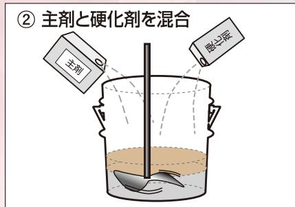
主剤と硬化剤をペール缶内にあけ混合、電動攪拌機にて充分攪拌する。
